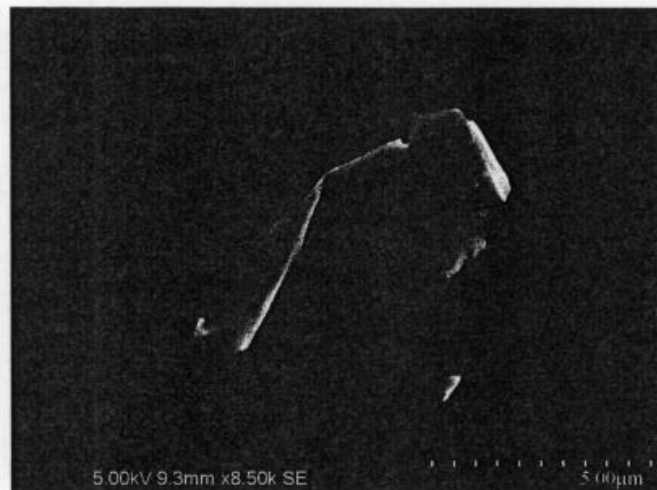
图 B.2 石墨烯锌粉涂料中石墨烯材料的扫描电镜形貌图 (物理法)
