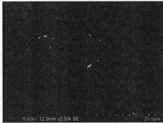
图 B.3 石墨烯锌粉涂料中石墨烯材料的扫描电镜形貌图 (改性石墨烯-1)
