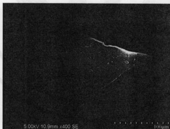
图 C.2 玻璃鳞片的扫描电镜形貌图
